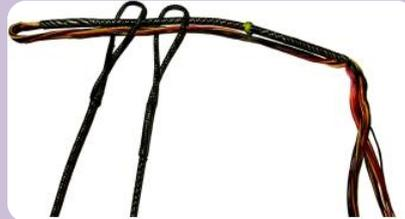
**L'ajustage du band se fait par vrillage de la corde** jusqu'à obtention de la distance souhaitée.
